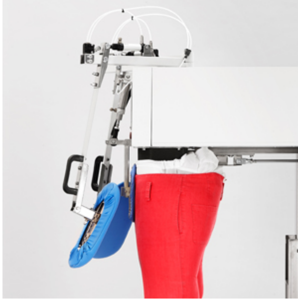
Tensionamento fronte/retro della cintura, con dispositivo anti-stretching
